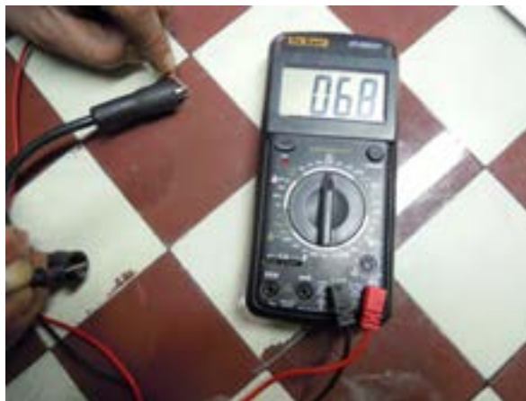
شکل ۴۳-۸- تست اهمی وایر شمع
