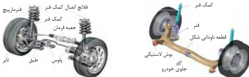
شکل ۳۶-۱- نمونه هایی از سیستم تعلیق و اجزای آن
