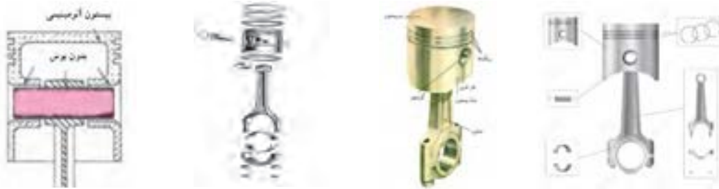
نقشه برش خورده قطعات مونتاژ شده
