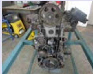
تایم موتور تک میل سوپاپ رو، نوع پولی و تسمه (پژو ۴۰۵)
