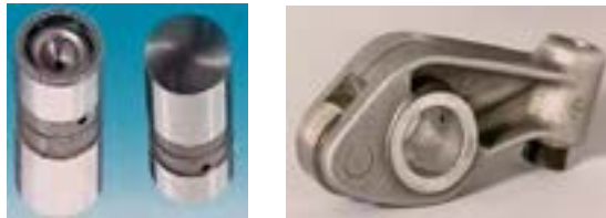
شکل ۸-۳۷ - دو نوع تنظیم‌کننده هیدرولیکی سوپاپ‌ها
