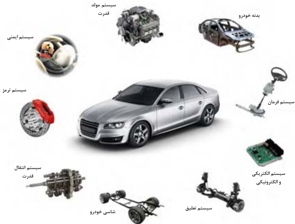
شکل ۱-۲- سیستم‌های مختلف خودرو
