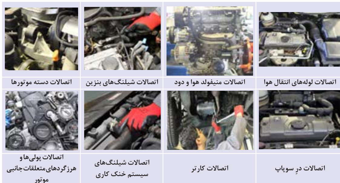
شکل ۱-۲۳ - بخش‌های مختلف سیستم مولد قدرت برای آچارکشی
