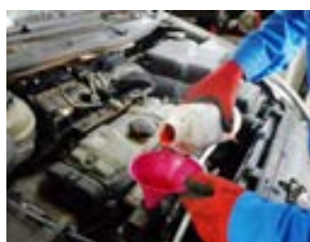
۱۲- پس از جدا کردن دستگاه و کیوم سطح مایع مخزن کنترل شده و در صورت لزوم به آن اضافه شود.
