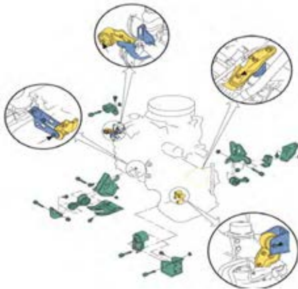
شکل ۹-۴ - محل نصب دسته‌موتور
