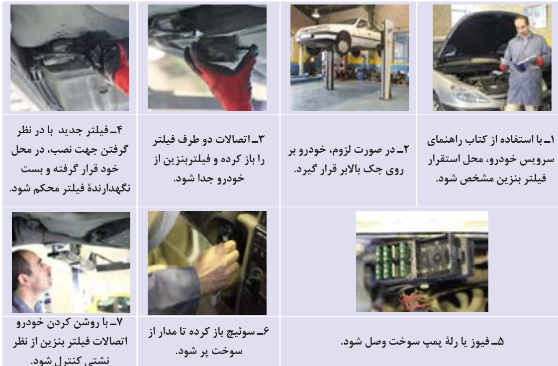
شکل ۳-۳۵ روش تعویض فیلتر بنزین
