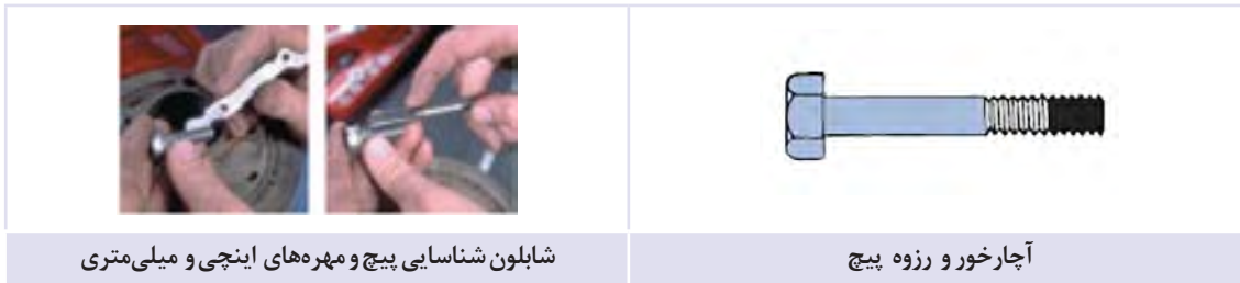
شکل ۱۳-۱ - شناسایی رزوه پیچ
