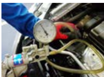
۵- خلأی در حدود 65 تا 85 kpa با کمک دستگاه و کیوم دستی ایجاد شود.
