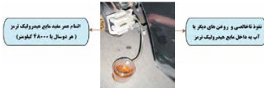
شکل ۹-۶- لزوم تخلیه کامل روغن هیدرولیک ترمز
