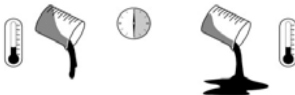
شکل ۳-۳- دو نوع سیال متفاوت در دمای یکسان
