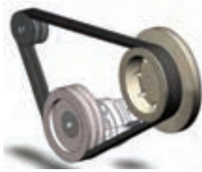
شکل ۲-۲- انتقال توان به کمک تسمه و پولی
