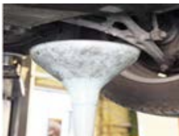
۳- مخزن جمع‌آوری روغن مستعمل زیر خودرو قرار گیرد.
