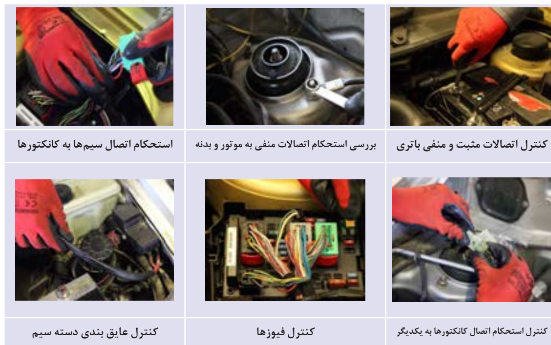
شکل ۳۸-۱- کنترل آچارکشی اتصالات مدارهای الکتریکی
