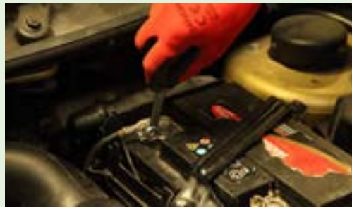
شکل ۱۹-۲- جدا کردن سر باتری
