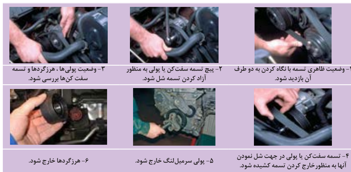
شکل ۲۲-۲ مراحل باز کردن تسمه و مکانیزم های آن
