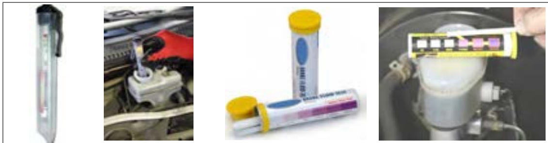
شکل ۶-۷- تست کیفیت مایع هیدرولیک ترمز
