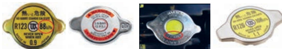
شکل ۷-۲۶- محل درج فشار عملکرد روی در چند رادیاتور
