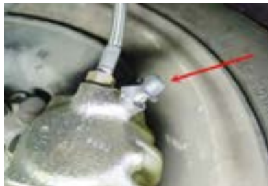
شکل ۱۰-۶- تخلیه مایع هیدرولیک ترمز به صورت دستی
