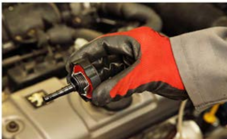
شکل ۹-۵- شاخص‌های روی درپوش مخزن مایع هیدرولیک فرمان
