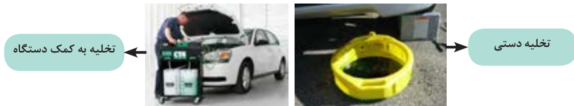
شکل ۲۸-۷- روش‌های تخلیه مایع خنک کننده
